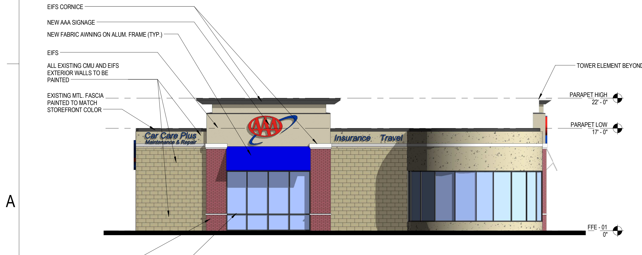
(A1) EAST ELEVATION SCALE: 1/8" = 1'-0"
